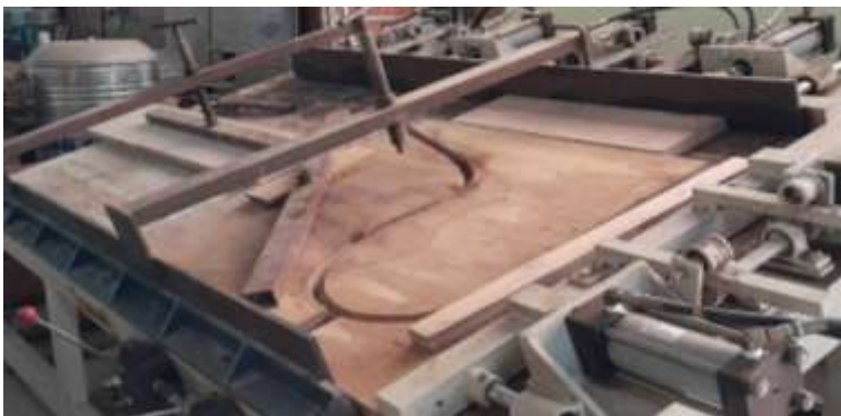
ຮູບພາບທີ 1: ແມ່ແບບ ແລະ ເຄື່ອງຈັກໃຊ້ຜະລິດຕະພັນຕັ້ງດັດໂຄງທີ່ນຳໃຊ້ເສດໄມ້ວິກ (K7)
