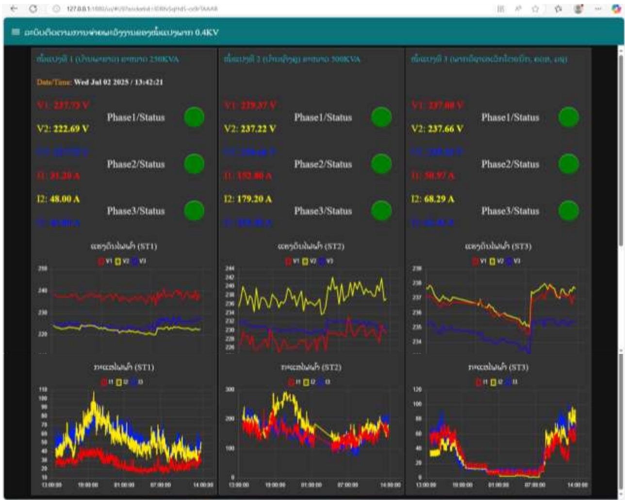
ຮູບພາບທີ 7: ໜ້າສະແດງຜົນສູນກາງການຕິດຕາມສະຖານະ ແຮງດັນ ແລະ ກະແສໄຟຟ້າຂອງໜ້າແບ່ງ
