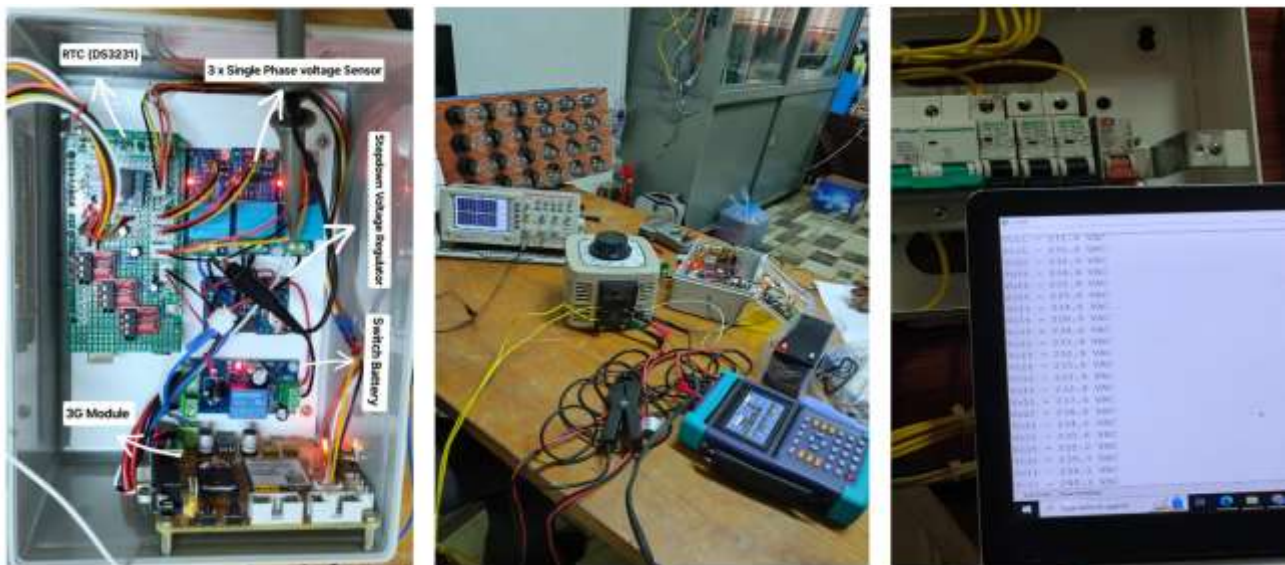
ຮູບພາບທີ 2: ການທົດສອບປະສິດທິພາບຂອງເຊັ່ນເຊີ ທຽບກັບເຄື່ອງມືວັດແທກມາດຕະຖານ
