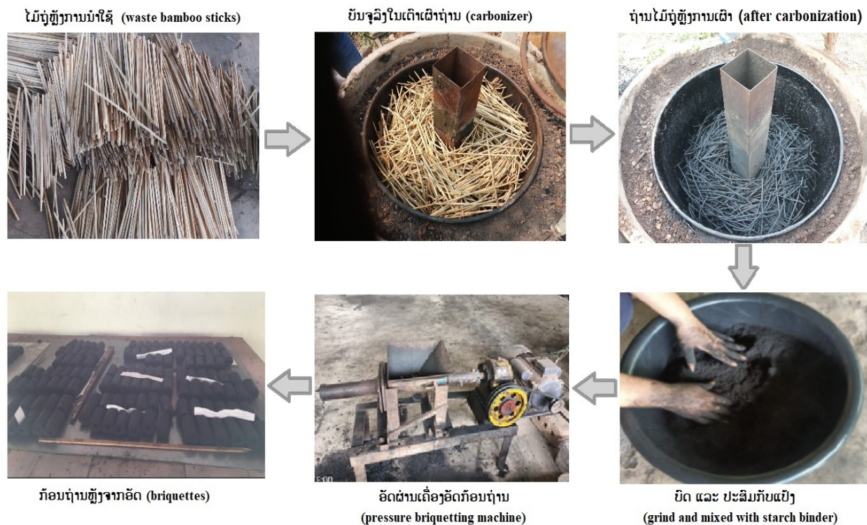
ຮູບພາບທີ 1: ຂັ້ນຕອນການຜະລິດຖ່ານອັດກ້ອນຈາກໄມ້ຖືກເສດເຫຼືອຫຼັງການນຳໃຊ້
