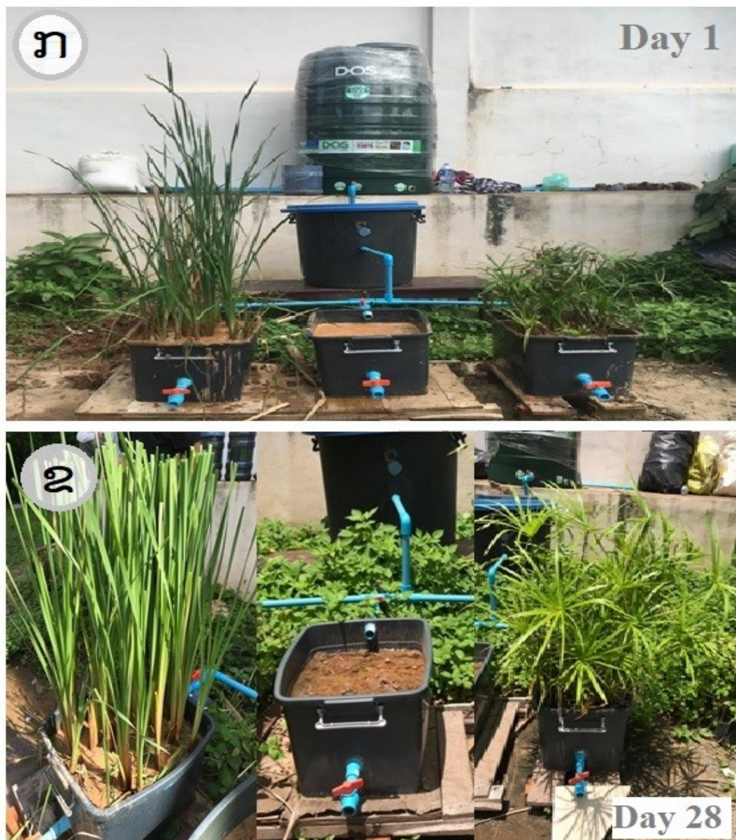
ຮູບພາບທີ 5: ລັກສະນະຂອງລະບົບກ່ອນ ແລະ ຫຼັງການບໍາບັດນໍ້າຊະຂີ້ເຫຍື້ອ. ກ) ມື້ທີ 1 ແລະ ຂ) ມື້ທີ 28 ຂອງການບໍາບັດ
