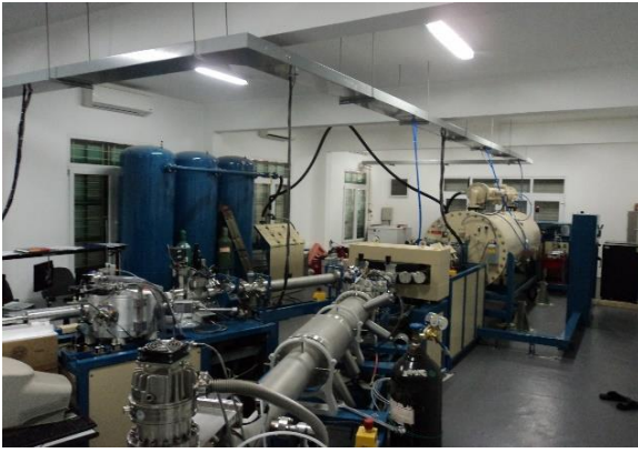
ໂຄງສ້າງຂອງ Tandem 5SDH-2 PELLETRON ຢູ່ຫ້ອງທົດ ພາກວິຊາຟີຊິກສາດ ມະຫາວິທະຍາໄລວິທະຍາສາດທຳມະຊາດ ຮຳໂນຍ ສ.ສ ຫວຽດນາມ
