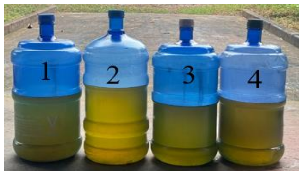
ຮູບ 3: ໂຕຢ່າງຂອງໄບໂອດີເຊລທີ່ໄດ້ຈາກການທົດລອງຫຼັງຈາກແຍກເອົາກລີເຊຣິນອອກແລ້ວ: 1) ກໍລະນີແຜ່ນອໍຣິຟິສຮູດງວຂະໜາດເສັ້ນຜ່າສູນກາງ 5 mm, 2) ກໍລະນີແຜ່ນອໍຣິຟິສຫຼາຍຮູດງວຂະໜາດເສັ້ນຜ່າສູນກາງ 2 mm, 3) ກໍລະນີແຜ່ນອໍຣິຟິສຮູດງວຂະໜາດເສັ້ນຜ່າສູນກາງ 4 mm, ແລະ 4) ກໍລະນີແຜ່ນອໍຣິຟິສຮູດງວຂະໜາດເສັ້ນຜ່າສູນກາງ 6 mm.
