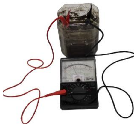
ຮູບພາບທີ 1: ສະແດງໂຄງປະກອບສ້າງຂອງບໍ່ໄຟຟ້າກາລວານິກ ແລະ ວິທີການວັດແທກຄ່າ OCV
